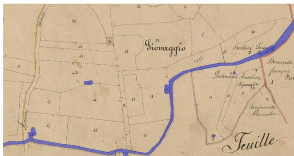
*Le chemin de l'eau : des réservoirs, au bord du Giovaggio, constitués d'un puits accolé à un bassin, ce dernier est destiné à recevoir l'eau extraite du puits à l'aide de la cicogna. L'irrigation du jardin peut alors se faire de manière gravitaire.*
