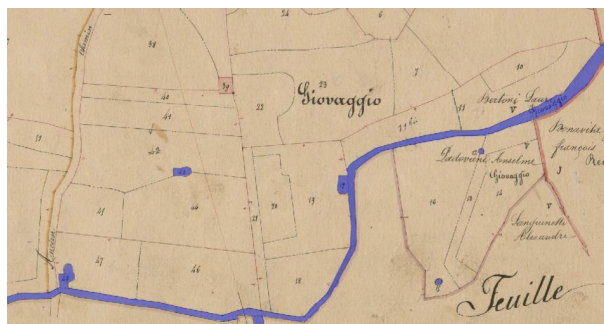
Le chemin de l'eau : des réservoirs, au bord du Giovaggio, constitués d'un puits accolé à un bassin, ce dernier est destiné à recevoir l'eau extraite du puits à l'aide de la cicogna. L'irrigation du jardin peut alors se faire de manière gravitaire.
